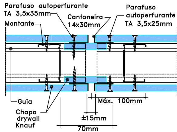
1 DETALHE – JUNTA DE DILATAÇÃO – W111
