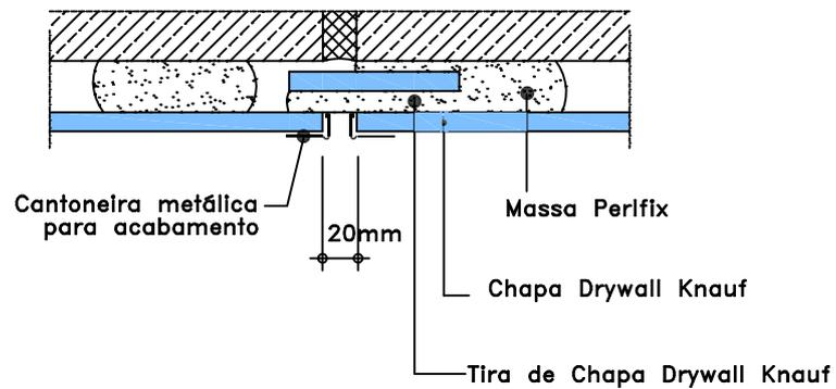
1 REVESTIMENTO COLADO 611 – JUNTA DE DILATAÇÃO
